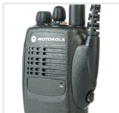
Připojení ovladače do konektoru radiostanice
